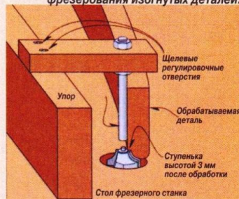
Рис. 7. Работа с приспособлением для фрезерования.
