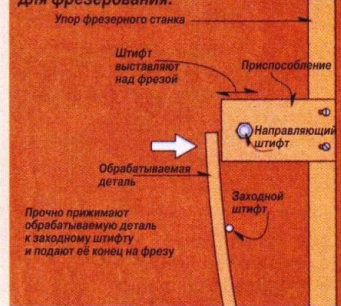
Рис. 7. Работа с приспособлением для фрезерования.
