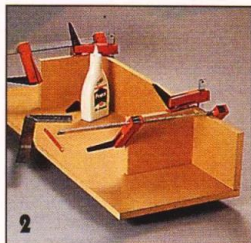
2 Заднюю стенку и перегородки приклеивают встык к нижней полочной доске, временно скрепляя детали струбцинами.
