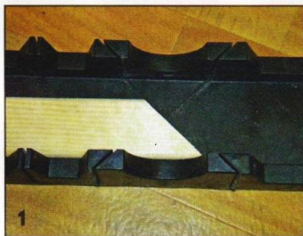
1 Детали рамы для зеркала сделал из наличников.
